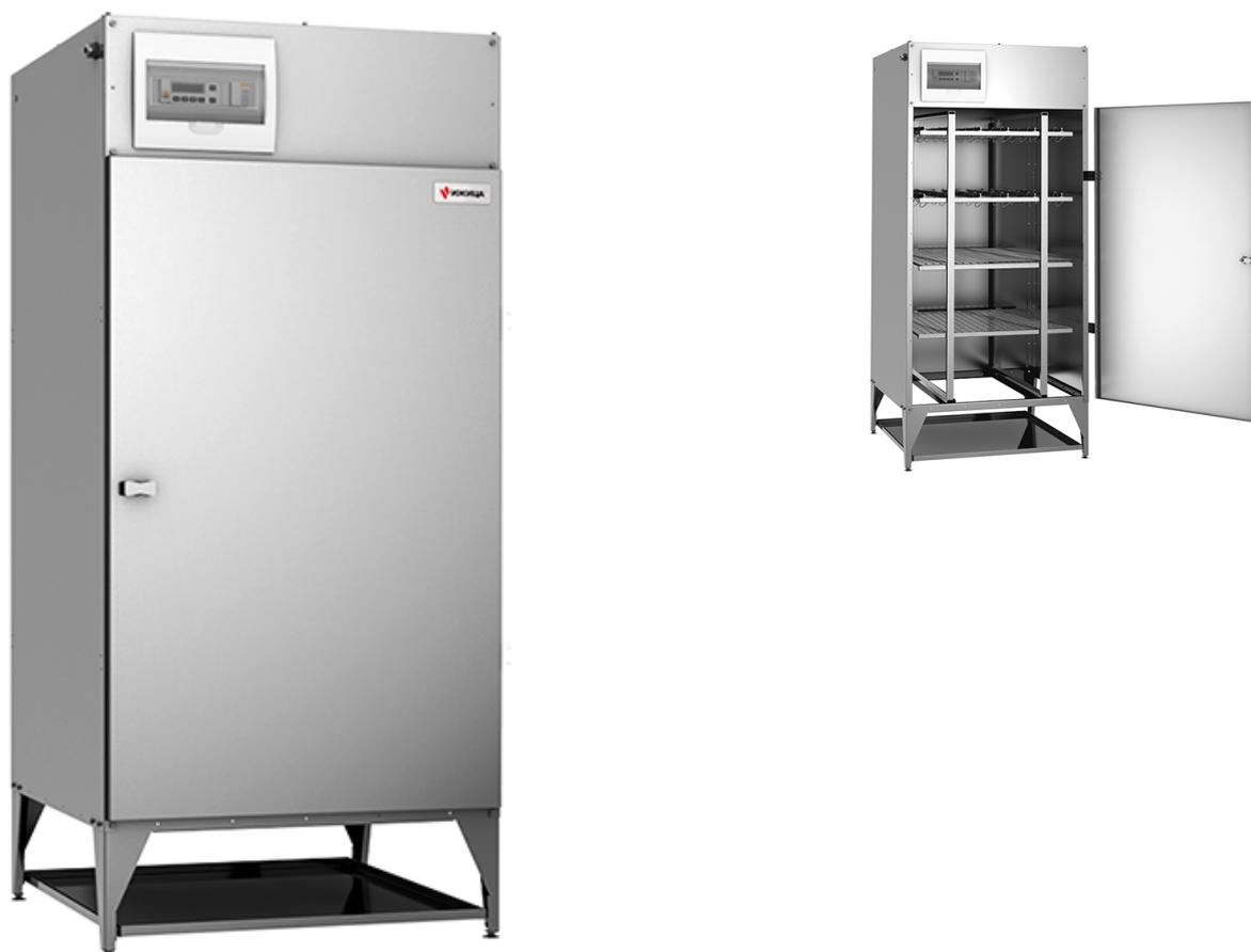
Ижица СВ-Н представляет собой шкаф из нержавеющей стали, в который помещается клеть с развешанной на ней продукцией. Благодаря периодическому действию центробежного вентилятора с мощностью потока 6000 м<sup>3</sup>/час, продукция быстро теряет влагу и приобретает необходимые свойства вяленого или подсушенного продукта
